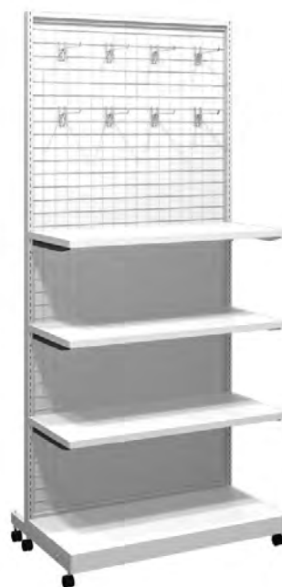
壁面什器 W900 (メッシュ) W:900 D:580 H:2050 ※サイズはフレームのみ ※バックパネルを外しメッシュのみの仕様も可能 パーツ / メッシュパネル ピンフック 棚
